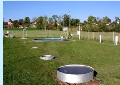
Výparoměry Class-A, GGI, v pozadí srovnávací výparoměr a meteorologické přístroje
